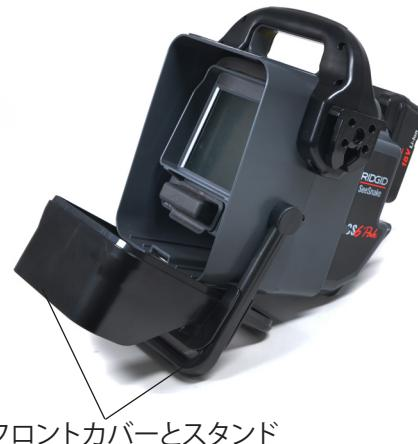
フロントカバーが開いた状態のときは、画面を見やすくかつ安定するようにフロントハンドルがスタンドの役目をします（上図）。フロントカバーを外すにはフロントハンドルの内側のレバーを引き、フロントハンドルを握り、下方に回転させます（引き下げます）。
