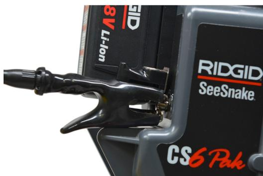
3. Ligue o transmissor e ajuste para a frequência desejada. Para obter melhores resultados, use frequências de 33 Hz ou mais.
